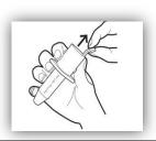
Paso 4: Empuje el pestillo (barra T) hacia atrás para abrir el mecanismo de cierre.
